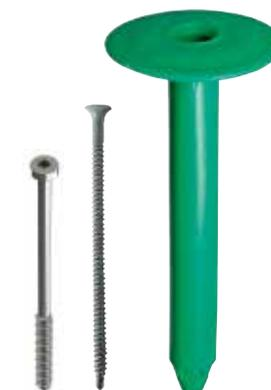
Диаметр фланца CROCO 50 мм позволяет крепить и жесткую, и мягкую изоляцию. Форма и внутреннее строение фланца позволяют выдерживать монтаж кровли газовой горелкой. При нагреве фланец выпрямляется и равномерно прижимает материал. При этом края фланца не деформируются, что позволяет сохранить герметичность шва кровельного материала. Стандартный цвет зеленый.
